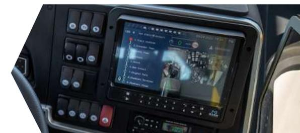
Monitor de sistema de cámaras con selector de visión y cambio automático ante apertura de puertas
