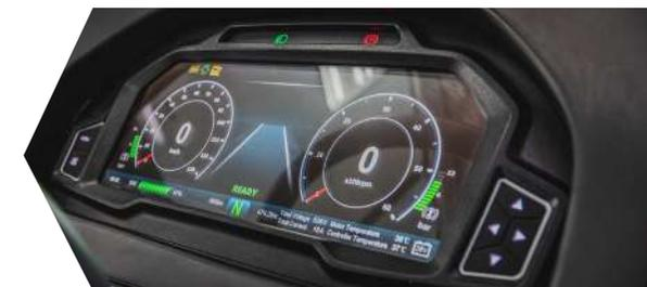
Panel de instrumentos digital con sistema de autodiagnóstico incorporado
