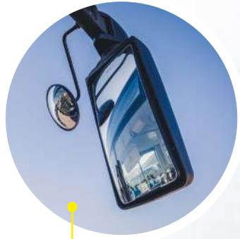
Espejos retrovisores de varilla mecánica, espejo hacia el interior.
