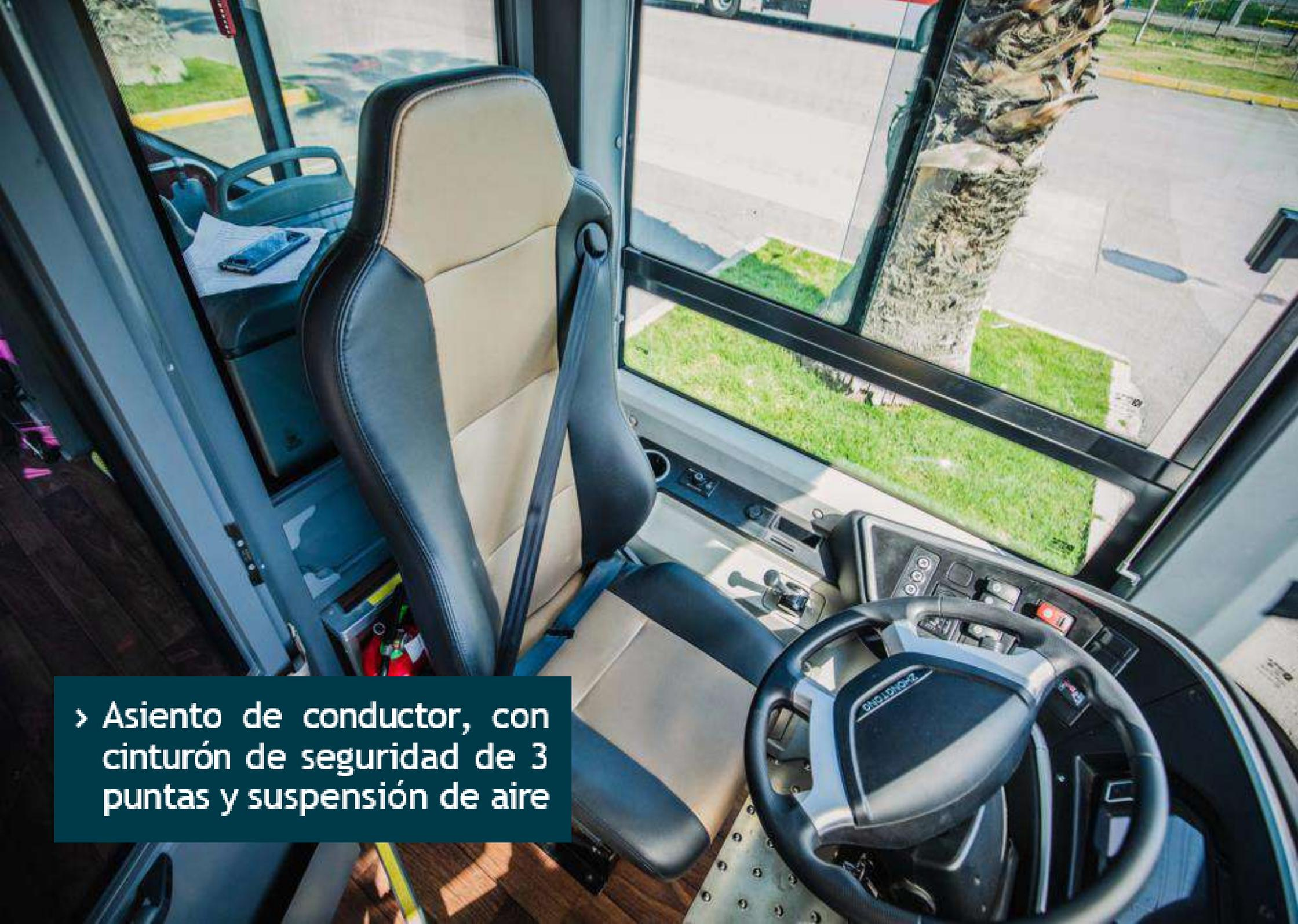
› Asiento de conductor, con cinturón de seguridad de 3 puntas y suspensión de aire
