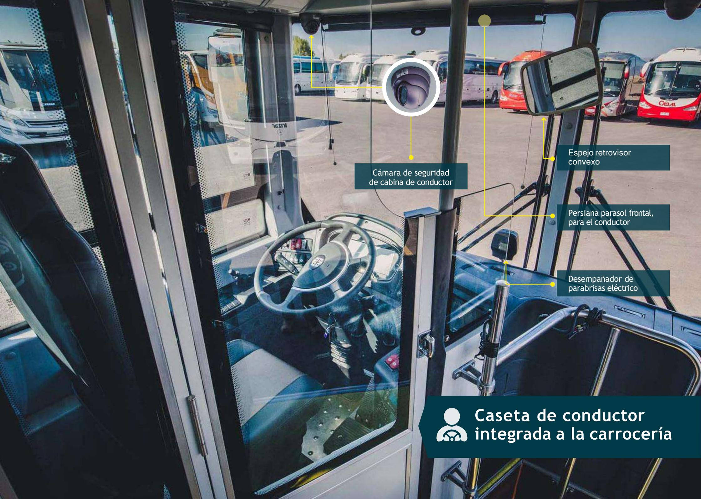
Cámara de seguridad de cabina de conductor
