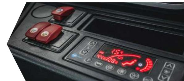
Sistema neumático para apertura de puertas y controlador de aire acondicionado
